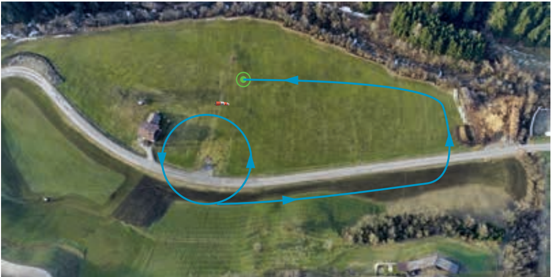
Abb. 7.6: Beispiellinkslandevolte: In diesem Beispiel ist der Landeplatz im unteren rechten Bildrand von einer Baumreihe und am oberen Bildrand von einem Bach und einem Waldgebiet begrenzt. Zusätzlich verläuft entlang der Straße eine Telefonleitung, die der Pilot beim Einfiegen in den Queranflug passieren muss. Geländebedingt ist dieser etwas kürzer, um mit keinem der Hindernisse zu kollidieren.
