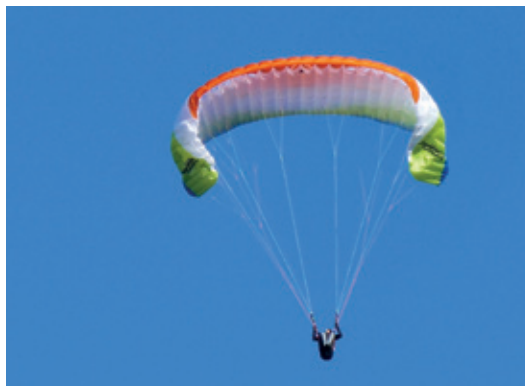
Abb. 9.12: Flugzustand mit angelegten Ohren • Bild: Papillon
